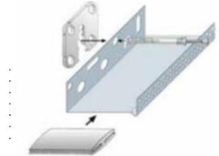
**Descripción** **weber.therm set montaje perfil arranque** es un conjunto de piezas especialmente indicadas para la ayuda en la instalación de **weber.therm perfil arranque**. El set está compuesto por espaciadores para salvar faltas de planimetría locales en los puntos a fijar del perfil de arranque, tornillería para fijar el perfil al soporte, y separadores a colocar entre perfiles para absorber dilataciones lineales del perfil.
